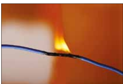
Рис. 3. Провод может загореться в результате искрения, возникшего в месте повреждения жилы, сопровождавшегося уменьшением ее сечения
