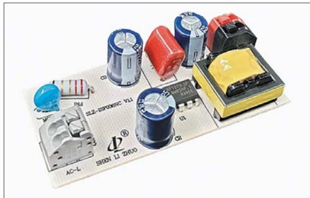
**Рис. 1.** Непонятный БП из Китая на 40 Вт без дорогих фильтров ЭМС/ЭМИ с явным нарушением ТР ТС (9 кГц — 300 МГц), если его применять в составе светильника без дополнительного дорогостоящего устройства
