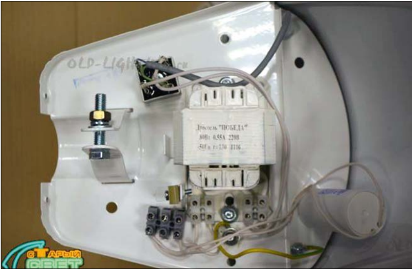
Рис. 2. Фотография ЭмПРА в старом корпусе 80 Вт светильника «Победа»
