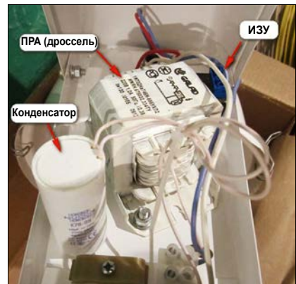
Рис. 5. Фотография ПРА в светильнике с ДНаТ лампой
